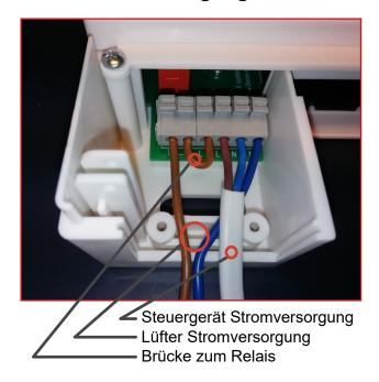
Mit dieser Schaltungsart können Sie die Lüfter oder andere Verbraucher direkt aus dem Steuergerät mit 230 V~ Strom versorgen.
